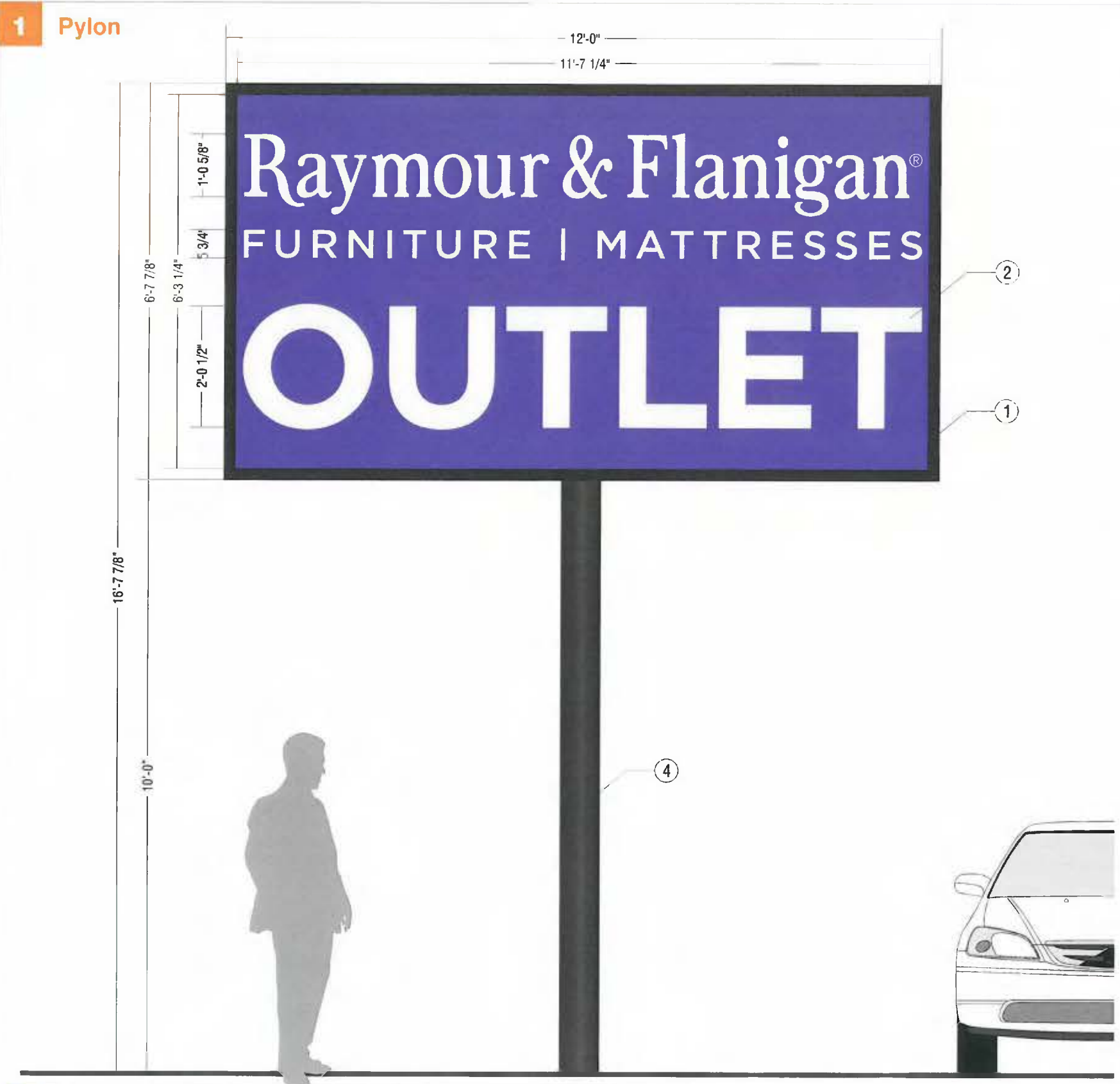
1 Pylon - Elevation 3 SCALE: 1/2" = 1'-0"
